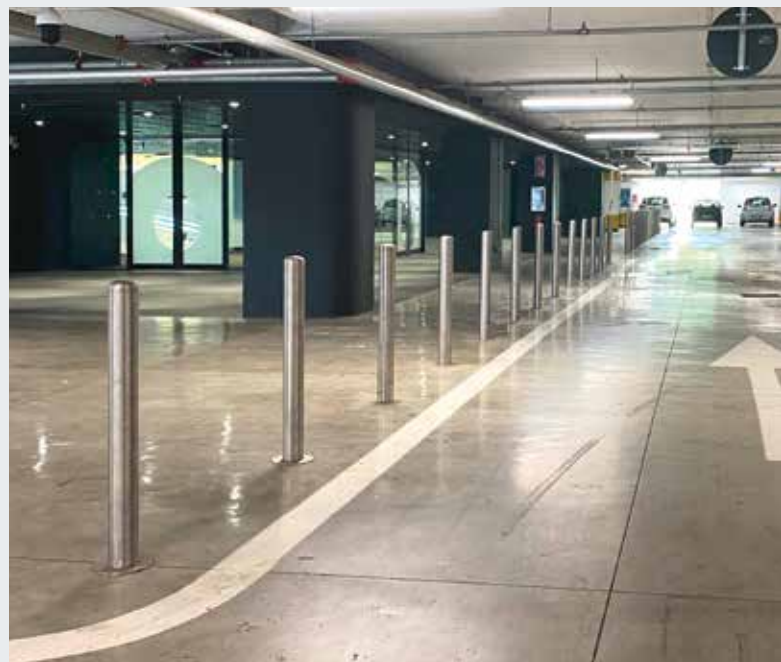
Bescherming van voetgangers door scheiding van rijbanen en voetpaden
